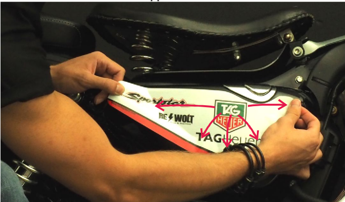
Kleben Sie den Aufkleber, indem Sie von der Mitte beginnen und Richtung Rand reiben, wie dies auch die Pfeile anzeigen.
