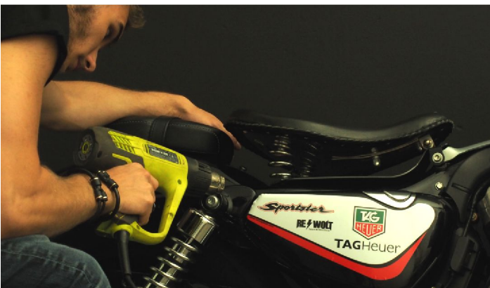
Verwenden Sie einen Anwärmer (oder einen Haarfön), um die letzten Luftblasen zu entfernen.
