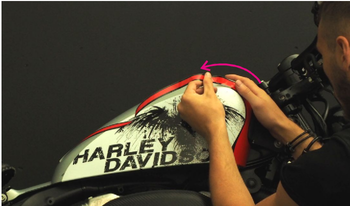
Kleben Sie den Streifen an den oberen Teil des Tanks an. Um das perfekt zu machen, kann das mehr als 20 Minuten dauern.
