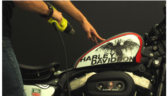
Glätten Sie alle Unebenheiten, indem Sie einen Anwärmer oder einen Föhn verwenden. Aber übertreiben Sie es nicht mit der Temperatur ... im Tank ist doch Benzin!
